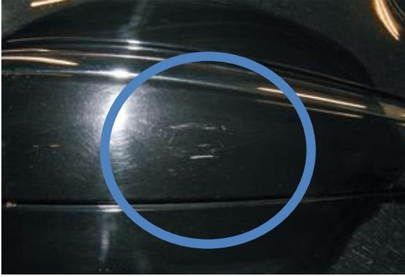
**Kratzbeschädigung bis auf die Grundierung**
