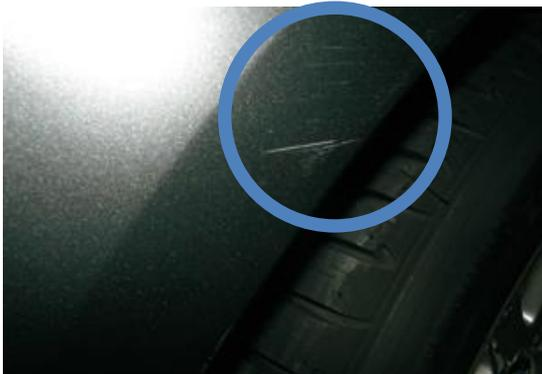
Kratzbeschädigung bis auf die Grundierung
