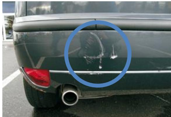
**Kratzbeschädigung bis auf die Grundierung**
