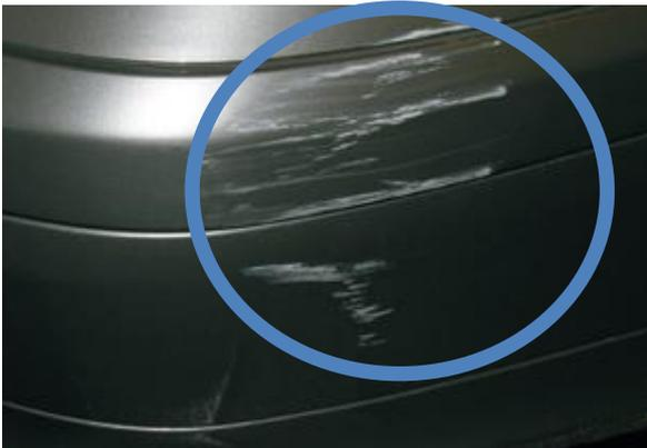
**Kratzbeschädigung bis auf die Grundierung**
