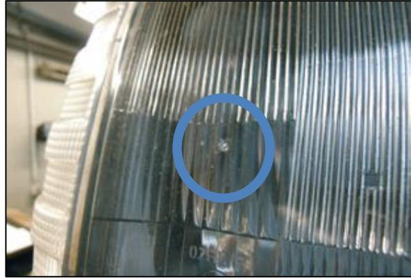
**Steinschlag am Frontscheinwerferglas (Halogen)**
