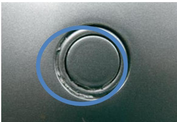
Einlackierungen aufgrund nicht durchgeführter Demontagerbeiten (hier einlackierter Einpark-sensor)
