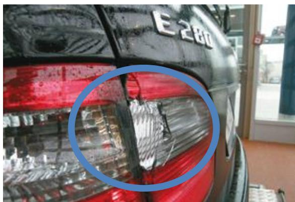
Beleuchtungseinheit und Heckdeckel beschädigt
