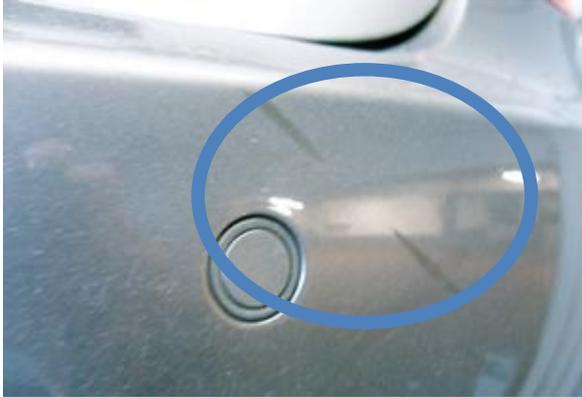
**Schleifspur/Abrieb auf dem Decklack**
