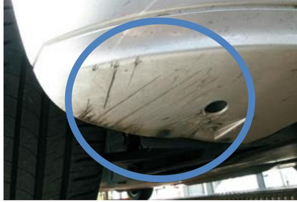
**Kratzbeschädigung bis auf die Grundierung**
