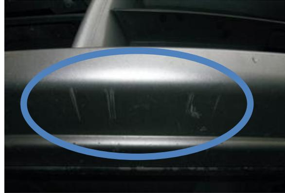
**Kratzbeschädigung außerhalb des Sichtbereiches**
