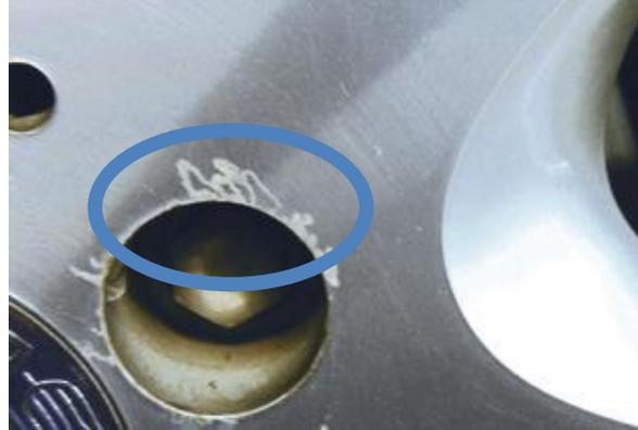
**Leichte Beschädigung bzw. Korrosion**
