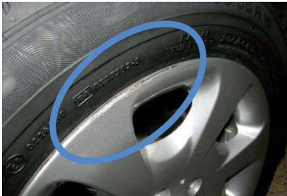
**Über das Felgenhorn verteilte Kratzbeschädigung**
